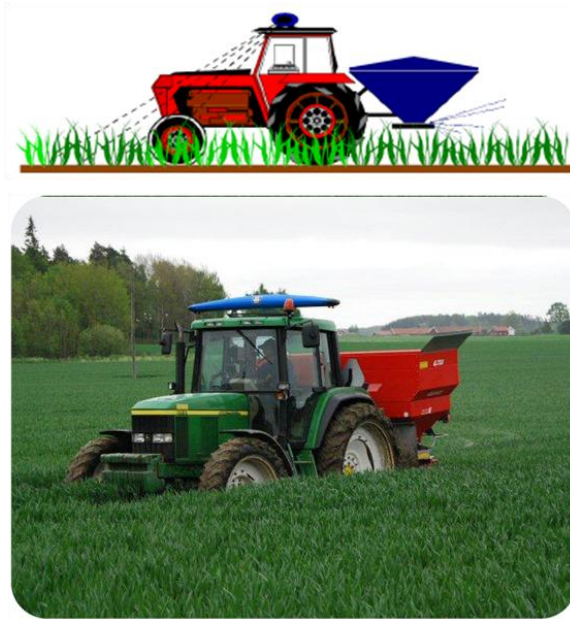
Figur 26. Principen för Yara N-sensor. Mätaren på traktorns tak mäter kontinuerligt färgen på grödorna för att på så sätt beräkna hur mycket gödsel som spridaren bör ge. 79
